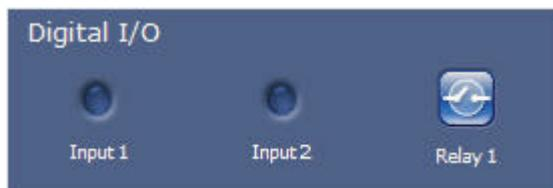
Les icônes d'alarme sont au nombre de trois : deux pour les règles d'alarme (règles 1 et 2, respectivement) et une pour le relais d'alarme. Affichée à titre informatif, l'icône d'alarme indique l'état d'une entrée d'alarme : lorsqu'une alarme est déclenchée, l'icône s'allume en bleu. Les connexions d'alarme et les paramètres des règles d'alarme de l'appareil déterminent si les icônes d'alarme sont activées.
