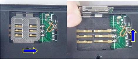
3 Mettre la carte de SIM dans le support, et refermer le clapet
