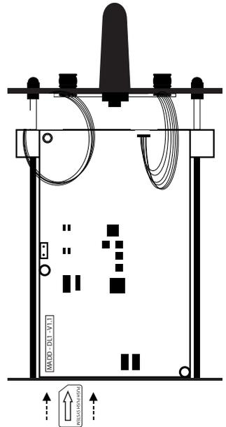
④ Replacer la station dans le boîtier en faisant attention aux fils.
