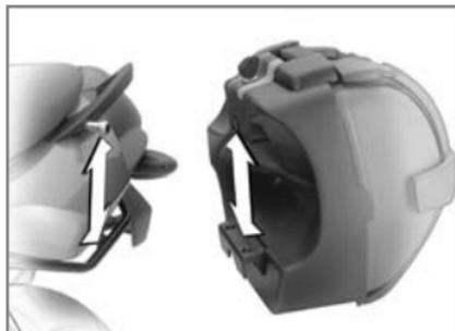
Si une valise est branlante ou ne peut être posée qu'avec difficulté, elle doit être adaptée du point de vue distance entre la fixation supérieure et la fixation inférieure. Pour cela, l'attache inférieure sur la valise peut être réglée en hauteur.
