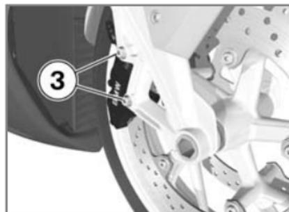
**!** A l'état déposé, les plaquettes de frein peuvent être comprimées au point de ne plus pouvoir être positionnées sur le disque de frein au remontage.
