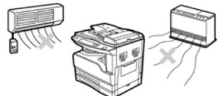
La machine doit être installée près d'une prise accessible pour pouvoir la brancher et la débrancher facilement.
