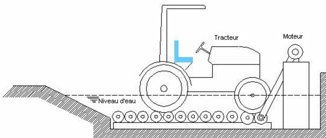
Figure 2.1 - Exemple de bassin pour l'essai d'étanchéité
