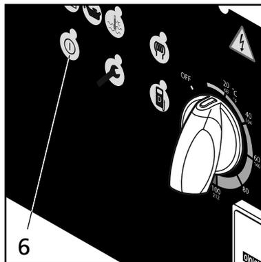
1. Mettre le commutateur sur la température souhaitée. Lorsque le témoin 6 s'allume, la machine est prête pour l'utilisation. Pour travailler avec une température supérieure à 100 °C, tourner le bouton (noir) de la pompe dans le sens horaire jusqu'à la butée de limitation.
