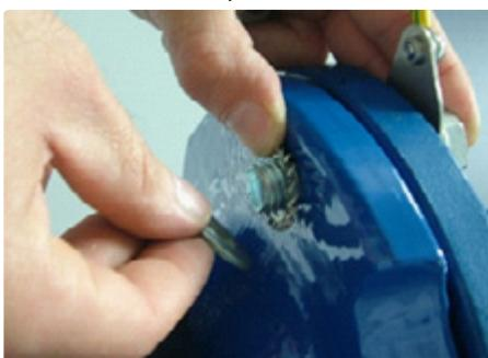
4. Rajoutez l'écrou et serrez. Assurez-vous que la cosse de raccordement en forme de fourche est en place.
