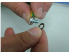
3. Insérez la rondelle crantée sur la rondelle plate
