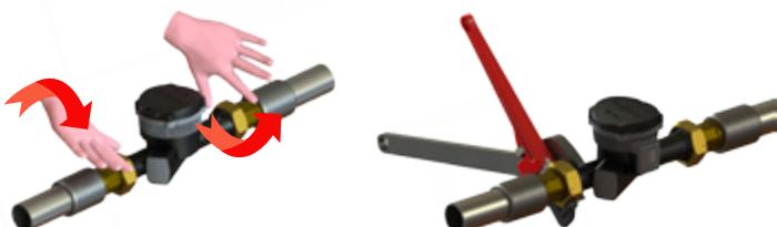
7. N'effectuez aucun soudage tant que l'appareil de mesure est relié au tuyau.
