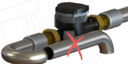
8. S'il est impossible d'utiliser des raccords en plastique (un côté au moins) veuillez stabiliser l'appareil comme indiqué sur le croquis ci-dessous.
