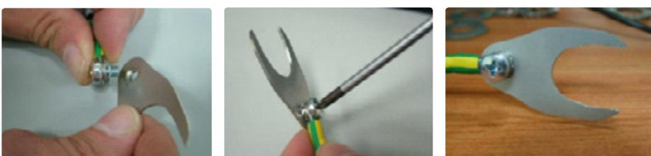
5. Insérez la rondelle plate et la rondelle crantée dans le boulon. Utilisez la rondelle adaptée à la taille du boulon (M16 ou M20 respectivement). Insérez le boulon dans le trou de la bride du tuyau.
