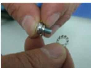
4. Rattachez-la à la cosse de raccordement à fourche et serrez
