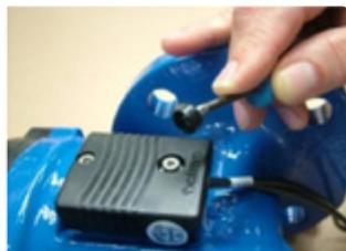
2. Retirez le joint d'étanchéité de l'hélice à l'aide d'un outil pointu.
