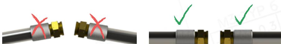
4. Avec les pièces de raccordement standard, n'utilisez que des joints en caoutchouc (pas de fibre de verre)! Une fois les joints en place, l'espace entre le raccord et le compteur d'eau ne doit pas dépasser 1 mm.
