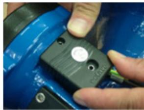
8. Vissez les deux vis à la main à l'aide de la clé à 6 pans de 3 mm pour obtenir une pression symétrique de l'anneau d'étanchéité,
