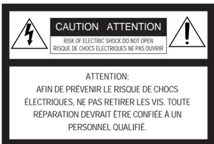
Le symbole de l'éclair dans un triangle équilatéral indique la présence d'une tension suffisamment élevée pour engendrer un risque de chocs électriques.
