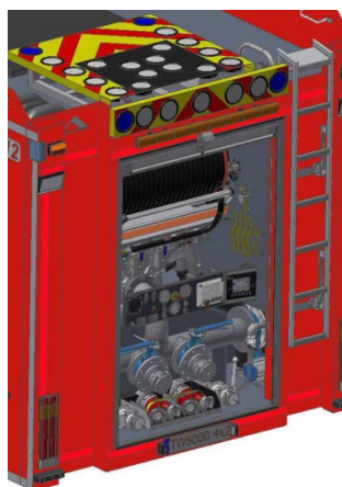
Vu arrière compartiment pompe
