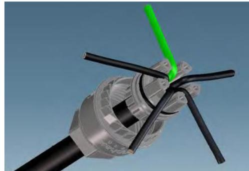
Si les conducteurs résistent lorsque vous appuyez sur l'embout, il est peut-être nécessaire de les recouper en utilisant une pince coupante.
