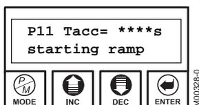
C'est le temps de rampe entré pour faire passer la tension de sortie sur le moteur de **Vsv** à la tension nominale du moteur.
