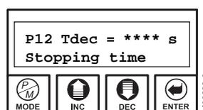
Le paramètre P12 définit le temps durant lequel la vitesse doit passer, pendant la rampe, de la valeur maximale à 0. Pour tout éclaircissement concernant la dynamo tachymétrique et les paramètres correspondants, voir le paragraphe 6.8.1.
