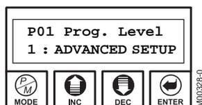
il permet d'accéder aux paramètres de **P00** à **P88** (moteur 0 sélectionné) ou bien de **P00A** à **P88A** (moteur A sélectionné) ou bien de **P00B** à **P88B** (moteur B sélectionné)
