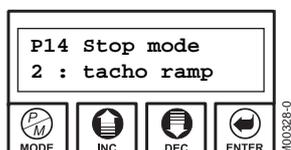
Arrêt **en rampe de vitesse**: peut être sélectionné uniquement en présence d'une rétroaction avec dynamo tachymétrique.
