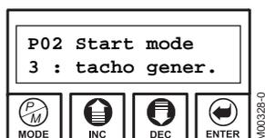
Démarrage **en rampe de vitesse**: peut être sélectionné uniquement en présence d'une rotation avec dynamo tachymétrique.
