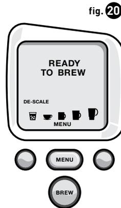
**fig. 20** La cafetière devrait subir un détartrage tous les trois à six mois pour assurer son fonctionnement optimal. Il arrive que le tartre s'accumule plus rapidement; il est alors nécessaire de procéder au détartrage plus souvent.
