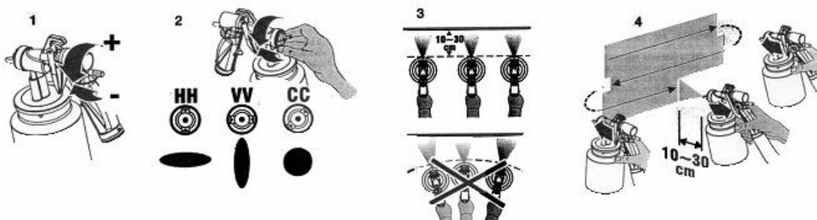
Les jets horizontaux ou verticaux (HH- VV) sont conseillés pour les grandes surfaces. La pulvérisation ronde (CC) est utilisée pour les petits objets ou pour les endroits plus difficiles à atteindre (angles, arrêtes, etc...).
