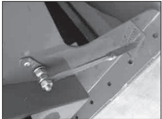
Presser le balai plus fort contre l'arbre de dosage (position -1 à -5 sur l'échelle) pour réduire le débit légèrement. Pour accroître le débit légèrement, (position +1 à +4 sur l'échelle) soulever le balai.
