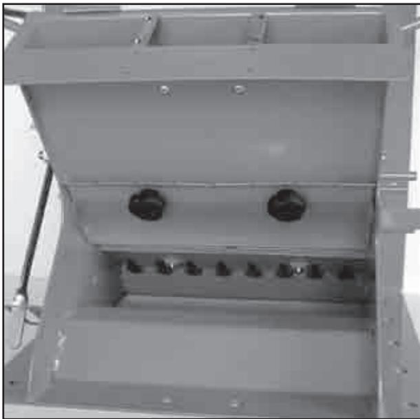
Fixer le tôle de calibrage à l'avant du semoir, au-dessus des tôles qui répartissent les graines.
