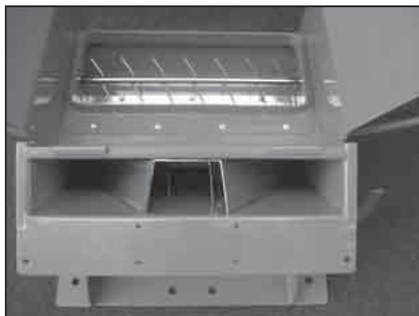
un déflecteur pour canaliser l'écoulement d'air
