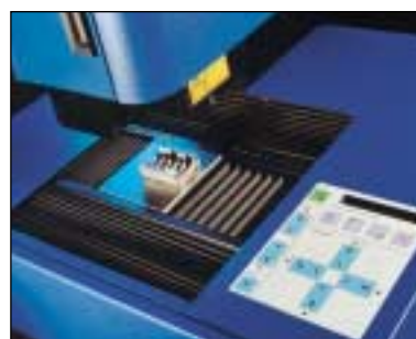
Talyscan 150 (détail de la platine de palpation X - Y)
