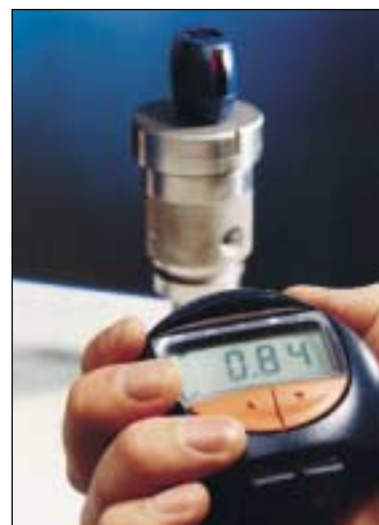
Le Surtronic Duo utilise une liaison infra-rouge (IrDA) entre les unités supérieure et inférieure pour assurer un fonctionnement à distance, sans câble, jusqu'à 1 mètre.
