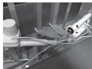
Guidez le câble du vérin de montée/descente de l'extrémité pieds du lit ET le câble du vérin du relevage-jambes à l'intérieur de la goupille du vérin du relevage-jambes. Assurez-vous que la goupille est correctement verrouillée.
