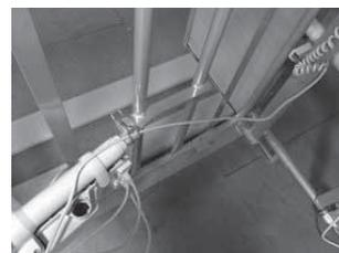
Placez le câble du vérin de montée/descente de l'extrémité tête sur les deux crochets à l'extrémité du lit et fixez le câble sur la goupille du vérin du dossier.
