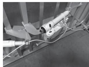
Connectez les deux prises des vérins de montée/descente (extrémité tête et extrémité pieds) à l'unité centrale placée sous le dossier.
