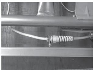
Fixez le câble secteur au serre-câbles fixé au châssis du lit.
