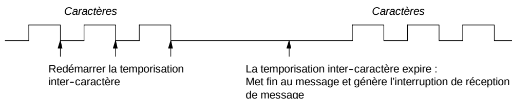
Figure 6-12 Utilisation de la temporisation inter-caractère pour arrêter l'opération Recevoir
