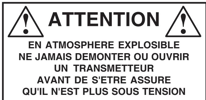
*L'instruction ci-dessus est applicable au mode de protection antidéflagrant par enveloppe (matériel EEx "d" suivant § 2.2). Elle ne s'applique pas aux autres modes de protection EEx "ia", EEx "nAL" et EEx "nL" comme décrits dans § 2.1 et § 2.3.*
