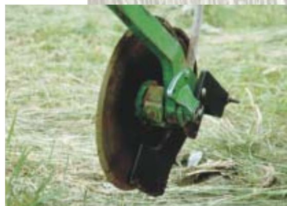
Système de distribution d'engrais liquides sur un semoir : disques à engrais de semoir
