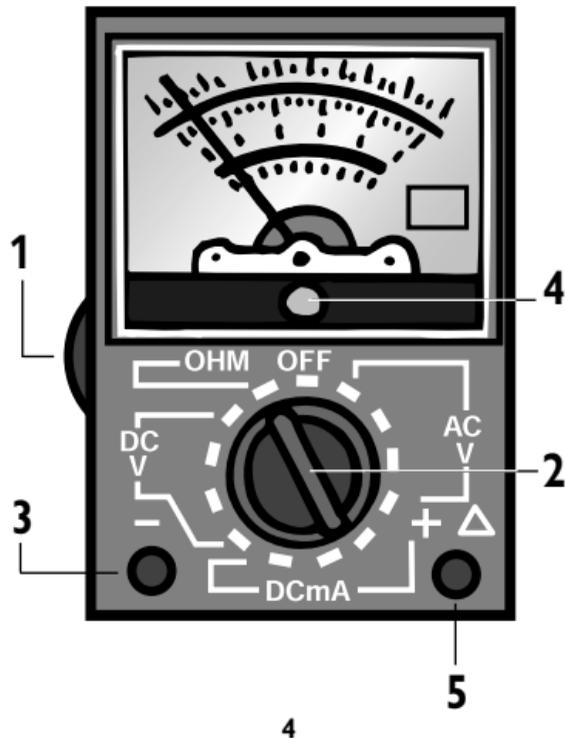
**1 - Molette de contrôle pour l'ajustement «électrique» de la lecture en Ohm : (tarage électrique)**
