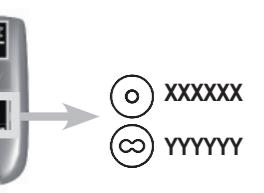
**! Każdy kod przycisku pilota może być użyty do zapisania w pamięci tylko jednego napędu. W przypadku użycia kodu do zapisania w pamięci kilku napędów, moduł TaHoma będzie sterował wszystkimi napędami jednocześnie.**
