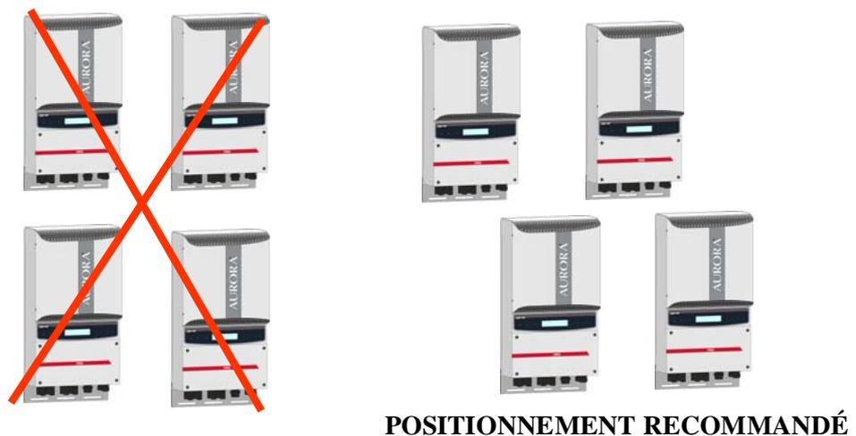
**Fig. 5 - Installation recommandée des onduleurs AURORA**
