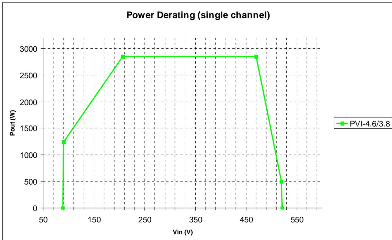
Fig. 29 - Comparaison entre la courbe de déclassement et la tension d'entrée –
