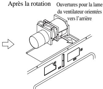
Faites pivoter le ventilateur dans le sens des aiguilles d'une montre de 180°
