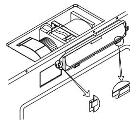
Ensuite, ajustez le tampon, remettez le couvercle du moteur du ventilateur en place à l'aide de la vis (1).
