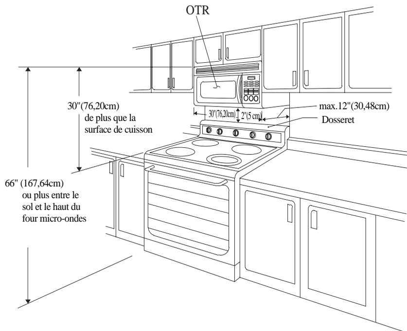
Votre four à micro-ondes au-dessus des autres a besoin d'un espace de montage sur un mur comme indiqué.
