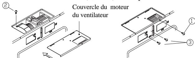
Faites se rejoindre avec soin les deux emplacements d'ouverture de l'évacuation du four à micro-ondes puis fixez le tampon au couvercle du moteur du ventilateur en la faisant glisser dans les guides du couvercle du moteur du ventilateur.
