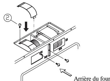
Faites correspondre attentivement l'emplacement de l'ouverture d'évacuation du micro-ondes puis fixez le tampon à la plaque arrière en faisant glisser dans les guides au centre en haut de la plaque arrière.
