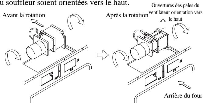
Faites pivoter le ventilateur dans le sens des aiguilles d'une montre de 90°
