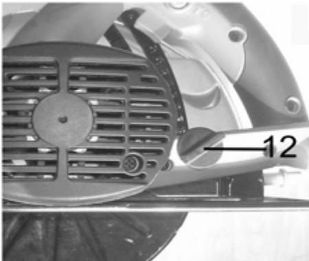
Pour obtenir une coupe optimale, la lame de scie ne doit dépasser le matériau que de **3 mm** au maximum.
