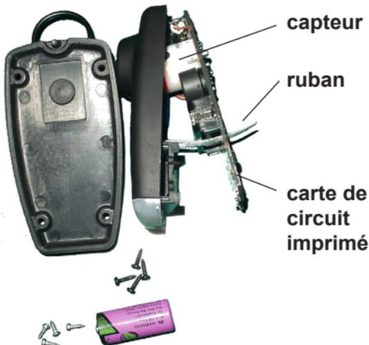
Assurez-vous que les broches ne sont pas pliées et qu'elles ne présentent pas de traces de corrosion. Alignez les broches sur les trous correspondants et appuyez. Le capteur doit s'encastrier sur la carte de circuit imprimé.
