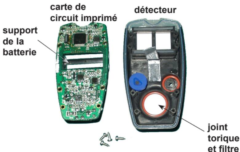
Retirez les quatre vis de la carte de circuit imprimé.
