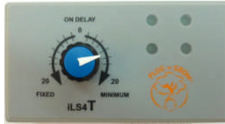
Figure 3 : Minuterie de délai de démarrage fixe ou minimum entre 0 et 20 minutes et allumant en séquence des sorties à toutes les 30 secondes.
