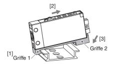
Engager la griffe 1 de l'adaptateur sur le rail DIN comme indiqué [1], appliquer une force d'effort dans la direction [2] indiquée, puis appuyer vers le bas horizontalement [3] jusqu'à ce que la griffe 2 clique sur le rail DIN.
