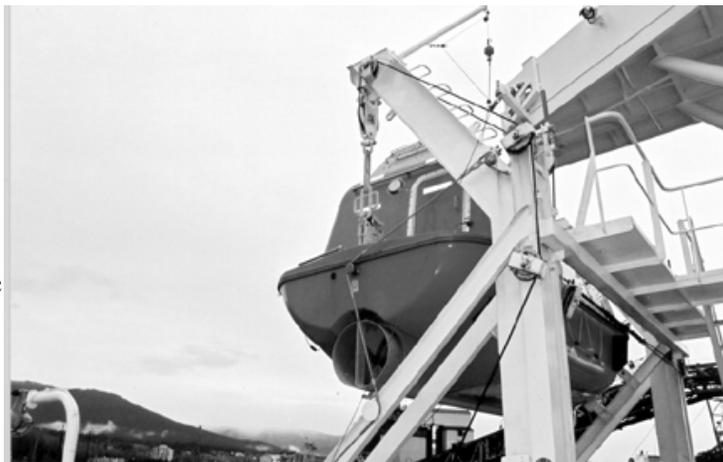
Chaque saisine est attachée à un bout à une platine à œil soudée au pont du navire; l'autre extrémité passe sur un levier pivotant librement fixé au côté du bossoir.
