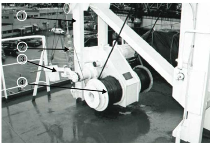
Des saisines en câble métallique passent sur ces bollards. Chaque saisine de 14 mm de diamètre a une tension de rupture de 13 000 kg – ce qui excède de loin le poids total de l'embarcation de sauvetage et de son contenu. La saisine est conçue pour maintenir fermement l'embarcation de sauvetage contre le cadre du bossoir de façon à l'empêcher de s'y cogner en mer.
