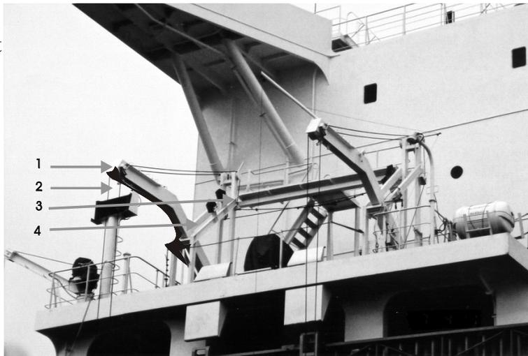
Un treuil électrique est boulonné au support arrière. Le treuil comporte deux tambours sur lesquels viennent s’enrouler les garants. Grâce à un système de réas et de poulies, les garants passent dans deux poulies flottantes auxquelles sont manillés deux anneaux de suspension. Chaque embarcation de sauvetage est dotée de deux crocs de suspente fixés en permanence, un à chaque bout.
