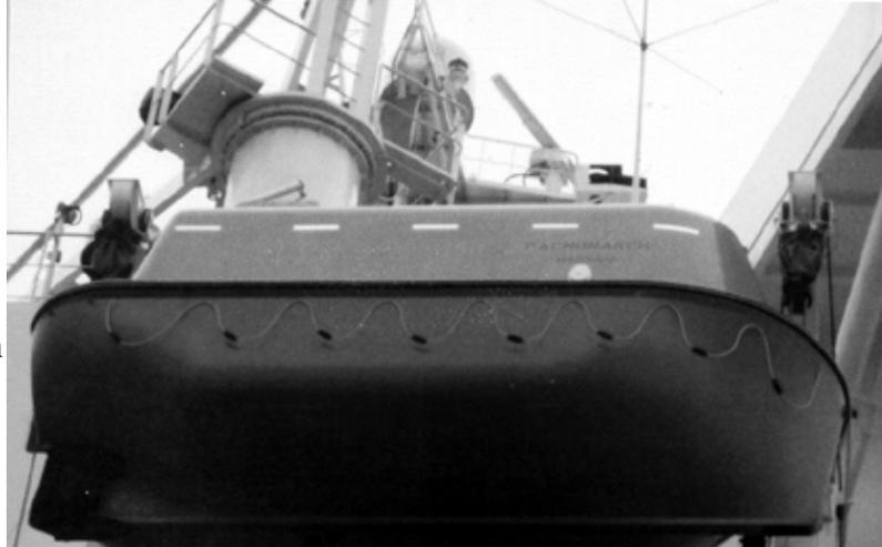
Le troisième panneau, situé à l'extrémité arrière de l'habitacle, est d'une longueur de 0,8 m sur 0,6 m de haut. Il permet d'atteindre le câble de remorque, la bosse et le croc de suspente arrière. Les trois panneaux sont fermés par des couvercles à charnières s'ouvrant vers l'intérieur de l'habitacle.
