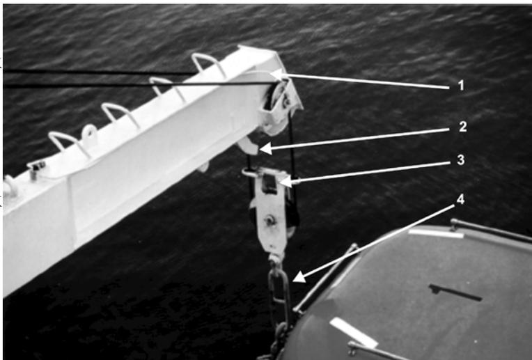
Le croc s'engage dans les anneaux de suspension, qui relient l'embarcation de sauvetage aux garants.
