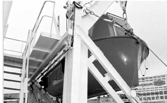
Lorsque l'embarcation de sauvetage est en position rentrée, le bout libre du levier pivotant appuie contre le support rigide du bossoir, l'empêchant de tourner.
