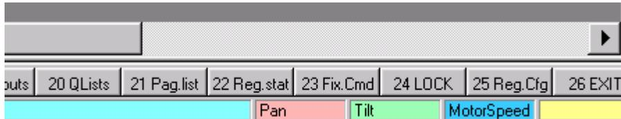
Les quatre sections de couleur Rouge, Vert, Bleu, Jaune, représentent respectivement le contrôle de quatre Wheels (roues). En appuyant le bouton **P/T**, on combine le contrôle des Attributs de "P/T", aux quatre encodeurs qui en gèrent les paramètres.
