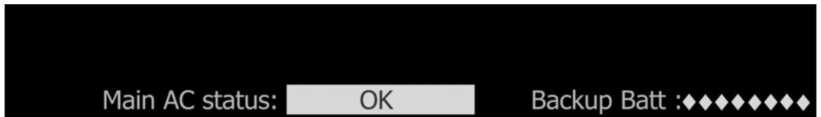
Dans le cas d'un manque inattendu de tension d'alimentation, l'indicateur de "Main AC status" indique tout en clignotant instantanément MISSING (manquante). En outre une fenêtre de "WARNING", se visualise sur le moniteur principal, en signalant une manque de tension et la conséquente activation de l'alimentation par la batterie de secours.
