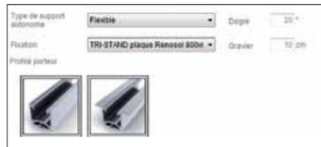
Saisie de l'angle en degrés et de la hauteur de gravier pour un châssis triangulaire à angle d'inclinaison variable.
