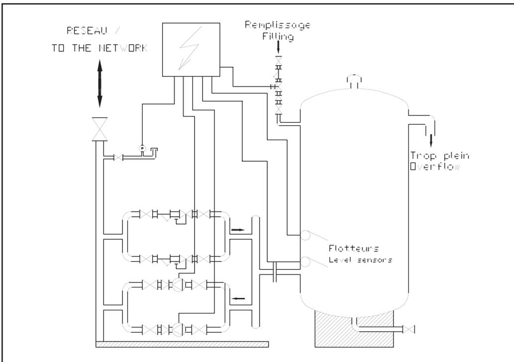
Lorsque l'installation monte en température, la pression augmente. Les déverseurs envoient alors l'eau dans la bache. Lorsque la température et la pression diminuent, la ou les pompes se mettent en marche afin de conserver la pression de consigne requise. Un système de capteurs de niveau permettent le remplissage automatique de bache, ainsi que l'arrêt pompe(s) en cas de niveau trop bas. Le régulateur assure le maintien de la consigne et gère les défauts éventuels.
