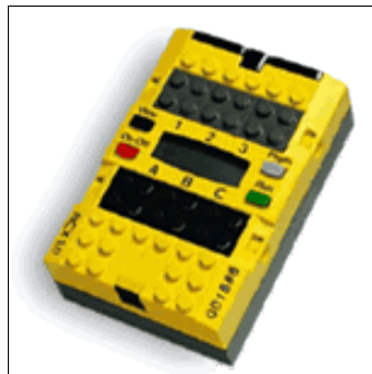
Figure 3.1 : La brique RCX.
