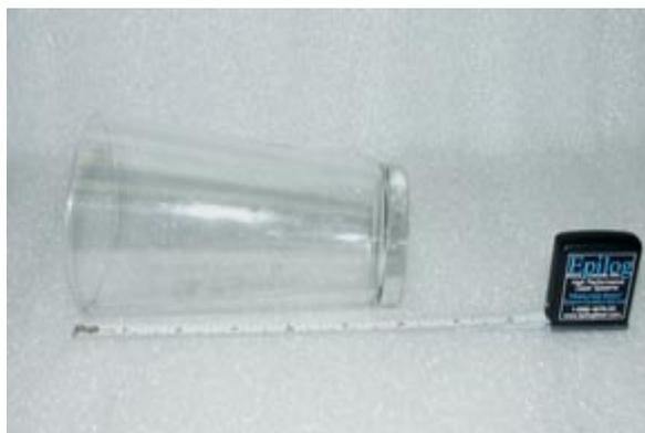
Pour la largeur de votre page, disposez le verre en l'orientant comme il doit l'être sur le tourne-cylindre. Pour ce verre, la largeur de la page sera de 152 mm.
