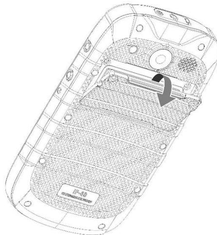
2. Le téléphone prend en charge deux cartes SIM. Insérez la carte SIM dans l'emplacement prévu, "côté circuit" vers le bas et alignez l'encoche de la carte avec l'encoche du réceptacle.
