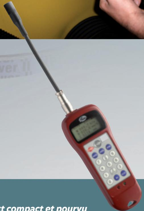
***Le tensiomètre est d'utilisation conviviale: il est compact et pourvu d'un logiciel qui permet d'enregistrer des données pour une utilisation répétitive. Le tensiomètre sonique de Gates donne une mesure précise, à chaque utilisation. Il est livré avec un manuel d'utilisation.***
