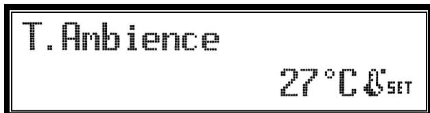
Premendo nuovamente i tasti P3(-) per decrementare e P4(+) per incrementare la temperatura ambiente, dopo avere impostato la temperatura ambiente, per uscire velocemente premere il tasto P1(ON/OFF).
