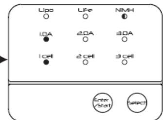
Appuyer sur « ENTER/START » pour sélectionner le type de batterie à charger. La LED va clignoter quand cela sera sélectionné
