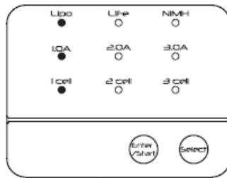
Appuyer sur « SELECT » plus de 3 secondes pour sélectionner le programme sur la première ligne de LED
