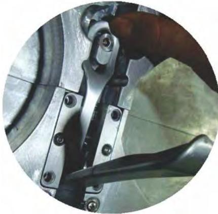
Effectuez les mêmes réglages au niveau de la vis du mécanisme de verrouillage sur tous les écrans. Si la profondeur de la vis n'est pas identique sur tous les écrans, il se peut que ces derniers soient mal alignés et qu'une tension irrégulière entre les écrans affecte la qualité d'image.
