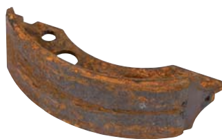
Mâchoires de frein non d'origine après 48 h de test en brouillard salin
