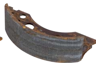
Mâchoires de freins AL-KO après 48 h de test en brouillard salin
