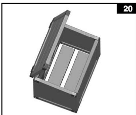
8. Placez l'épurateur à l'intérieur du coffre. Le cordon électrique et les tuyaux peuvent passer à travers le trou du panneau arrière.
