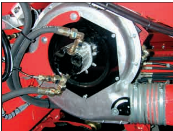
Moteur de la soufflerie (version avec clapet d'étranglement pas en série)
