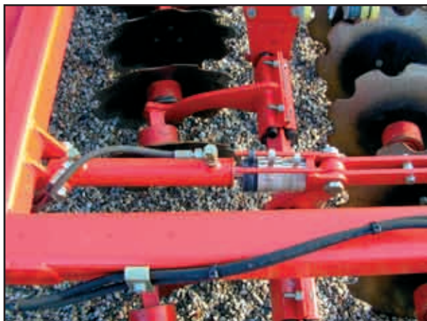
Réglage de la profondeur vérin hydraulique avec clips en aluminium.
