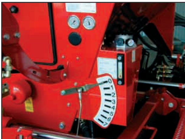
Réservoir d'huile hydraulique avec filtre, manomètre pour la pression de retour et le contrôle du niveau d'huile.
