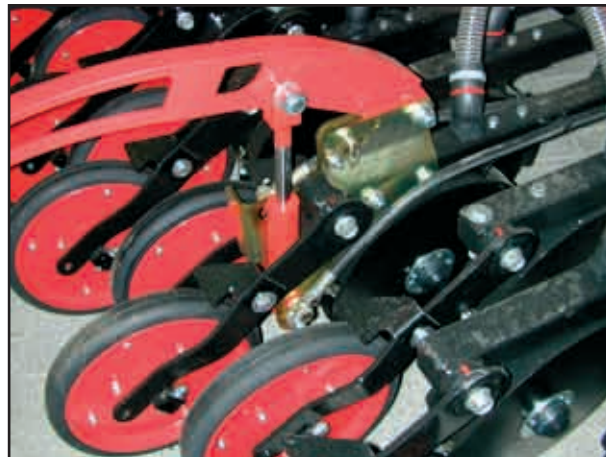
Réglage de la hauteur sur le jalonneur de pré-levée
