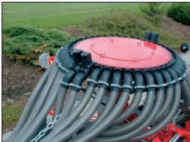
Distributeur de semence avec clapet magnétique
