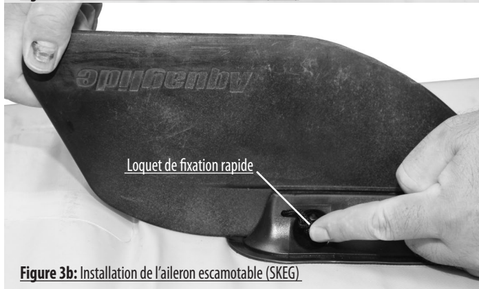
Figure 3a: Installation de l'aileron escamotable (SKEG)
