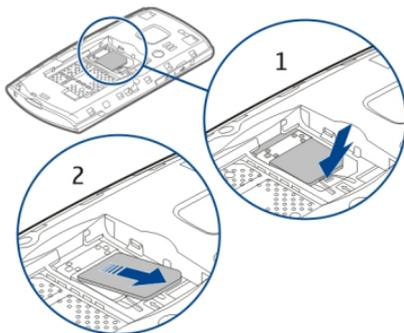
Appuyez sur le ressort de déverrouillage (1) et faites glisser la carte SIM pour la retirer (2).
