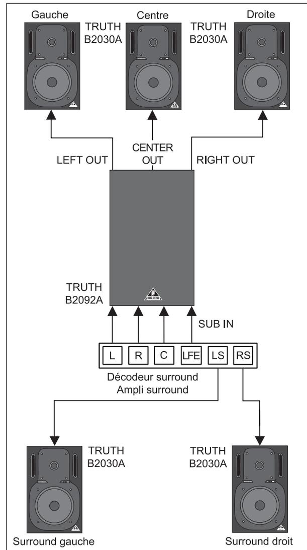
Fig. 3.2 : Exemple de câblage avec un système surround
