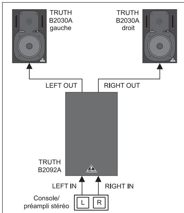
Fig. 3.1 : Câblage avec un système stéréo
