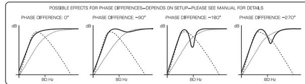
Fig. 3.4 : Conséquence des déplacements de phase sur la réponse en fréquences
