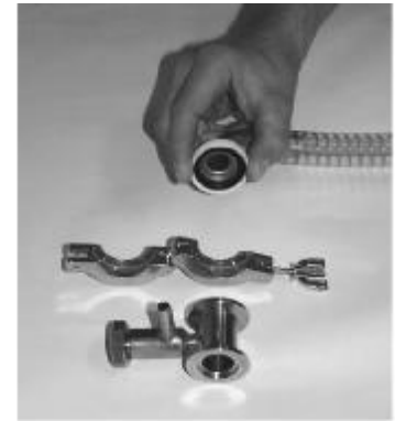
B Placer la bague de centrage sur un côté de la connexion à petite bride (par exemple tuyau de vide).
