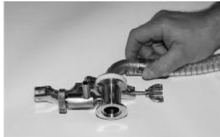
C Connecter la deuxième bride (la bague de centrage doit être correctement positionnée !), placer la bride de fixation sur la connexion et appuyer une sur l'autre.
