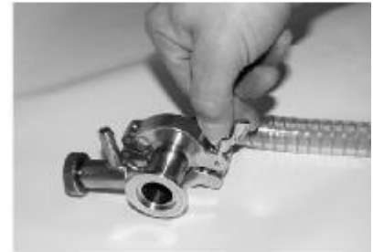
D Serrer à la main la vis de la bride de fixation.
