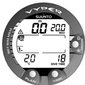
Fig. 3.27. Affichage surface. Le plongeur a fait surface après une immersion de 18 minutes à la profondeur maximum de 20,0 m. La profondeur instantanée est 0,0 m. Le voyant en forme d'avion indique l'interdiction de vol et le voyant attention que l'intervalle surface doit être prolongé.
