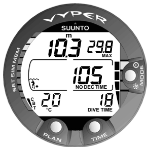
Fig. 3.12. Indicateur de vitesse de remontée. Quatre segments.
