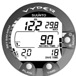
Fig. 3.11. Indicateur de vitesse de remontée. Trois segments.
