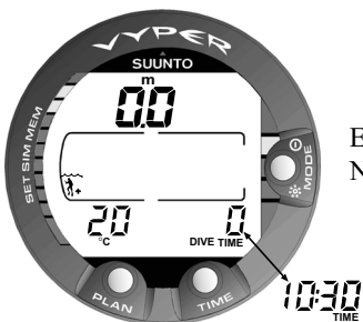
Fig 3.4. Affichage mise en marche IV. Affichage surface: la profondeur et le temps d'immersion sont à zéro (aucune plongée n'a encore été effectuée) et la température est de 20°C.
