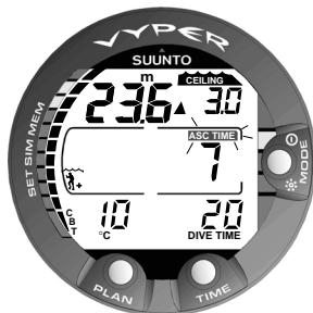
Fig. 3.16. Plongée avec décompression, en dessous de la profondeur plancher. La flèche pointant vers le haut et la mention clignotante ASC TIME recommandent de remonter. La durée totale de remontée minimum incluant le palier de sécurité est de 7 minutes. La profondeur plafond est à 3 m.
