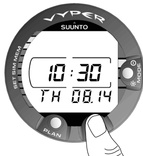
Fig. 2.1. Affichage montre. Cet affichage apparaît en appuyant sur les boutons PLAN ou TIME.
