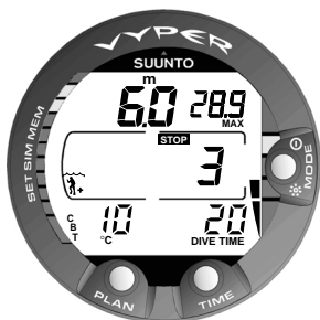
Fig. 3.10. Indicateur de vitesse de remontée. Deux segments.
