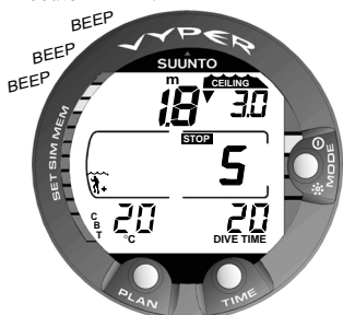
Fig. 3.14. Palier de sécurité obligatoire. Le plongeur doit effectuer un palier de sécurité obligatoire dans la zone de profondeur comprise entre 6 et 3 m. L'affichage alterné s'obtient en appuyant sur le bouton TIME.
