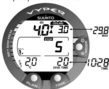
Fig. 3.14. Palier de sécurité obligatoire. Le plongeur doit effectuer un palier de sécurité obligatoire dans la zone de profondeur comprise entre 6 et 3 m. L'affichage alterné s'obtient en appuyant sur le bouton TIME.
