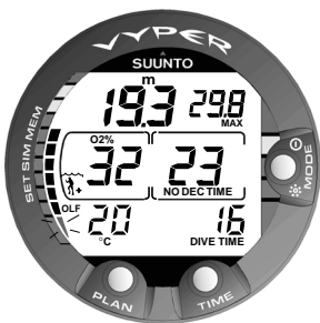
Fig. 3.25. L'OTU atteint la limite de toxicité SNC. Le segment inférieur commence à clignoter.
