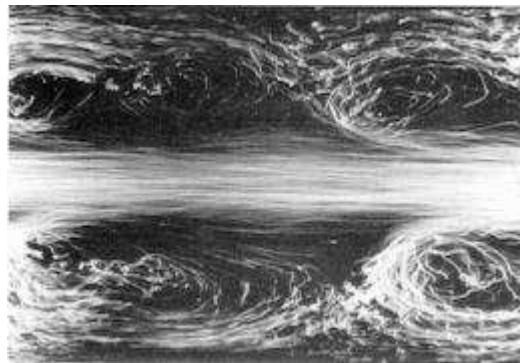
Figure 36 : Apparition des tourbillons dans un lit composé, Ref []
