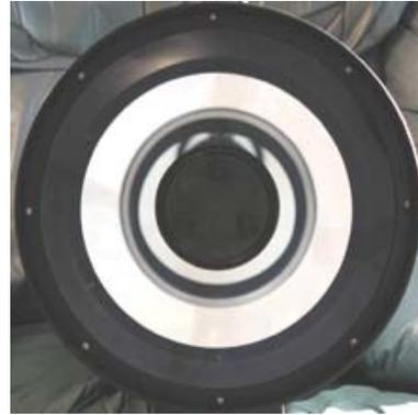
**Figure 2.** Aspect du miroir avec une mauvaise collimation.
