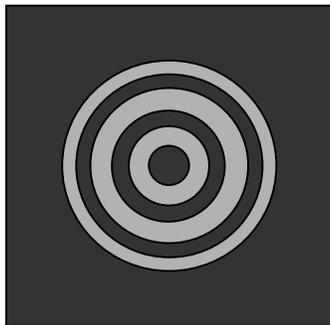
**Figure 3.** Aspect d'une étoile avec une bonne collimation.
