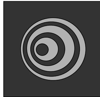
**Figure 4.** Aspect d'une étoile avec une mauvaise collimation.
