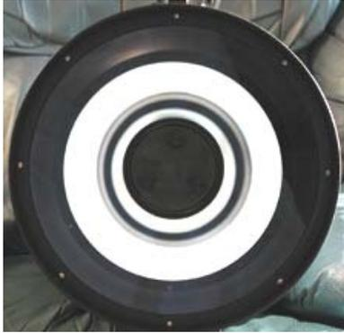
**Figure 1.** Aspect du miroir avec une bonne collimation.
