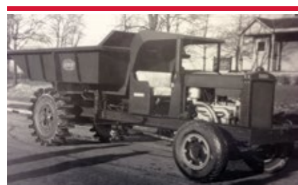
1934 Tombereau Model 1Z : considéré comme le premier vrai camion de chantier à bascule arrière.
